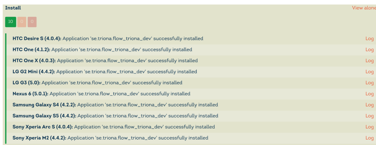
Figur 7 - Sammanställning av utförd installationstest av App1 på flertal enheter i AppThwack.
